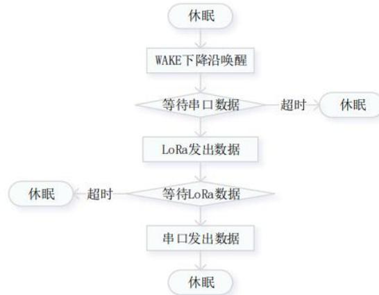
图 10 LSR 工作流程
